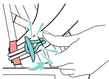
Nachdem Sie den Knebel durch die Sitzeinstellschlaufe geführt haben, arretieren Sie ihn, indem Sie ihn 90° zur Beinstützenschlaufe drehen.
